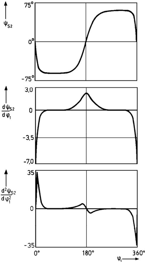
**Bild 2.** Übertragungsfunktionen 0. bis 2. Ordnung
