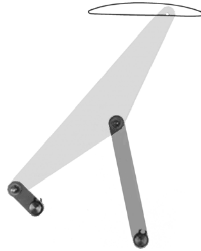
Bild 1. Kurbelschwinge als Ersatzgetriebe eines Meyer zur Capellen-Lenkens
