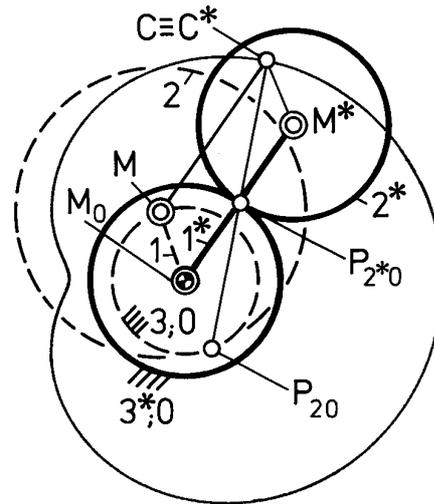
**Bild 2.** Ersatzrädergetriebe zur Erzeugung der gleichen geschweiften Pascalschen Kurve wie mit dem Getriebe nach Bild 1
