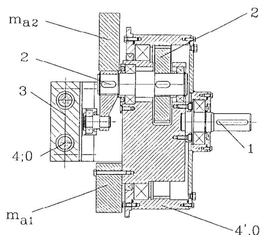
**Bild 3.** Konstruktive Ausführung des Räderkurbelgetriebes
