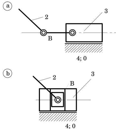
**Bild 2.** Gelenkige Verbindung zwischen den Gliedern 2 und 3 mit zwei Freiheitsgraden
