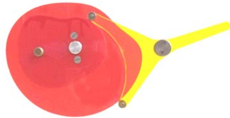
Bild 4. Komplementärkurvengetriebe mit drehendem Abtrieb
