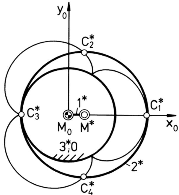
**Bild 2.** Ersatzrädergetriebe zur Erzeugung der gleichen gespitzten Epizykloide wie mit dem Getriebe nach Bild 1
