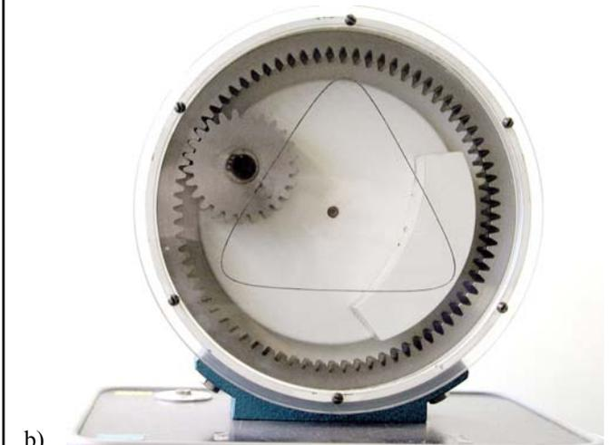
**Bild 1.** Rädergetriebe zur Erzeugung einer dreieckigen Hypozykloide
