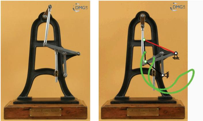
**Bild 6:** Beispiel für ein durch eine Animation angereichertes Bild eines Reuleaux-Modells
